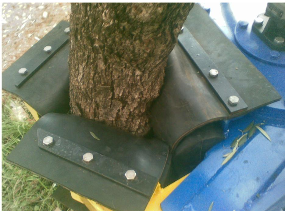
Sistema di chiusura a tre punti con pivot interno, conferisce la massima superficie di aderenza per la massima trasmissione della vibrazione, andando ad ottenere le migliori performance di raccolta.
