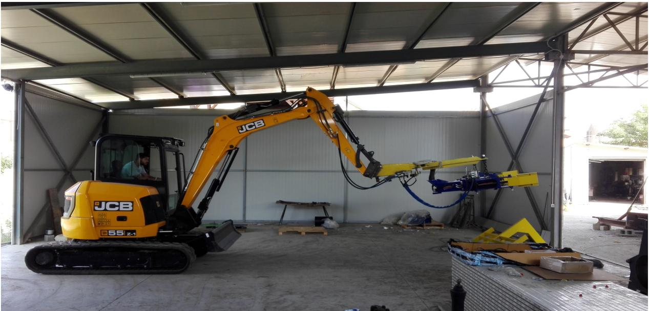
La pinza vibrante Vortex J grazie alle caratteristiche costruttive che la distinguono dagli scuotitori più tradizionali, riesce anche in presenza di potenze idrauliche modeste a generare prestazioni in linea se non superiori a macchine più potenti.
