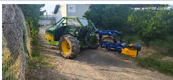
ENGANCHE TRASERO AL TRACTOR Y JUNTA CARDÁNICA
