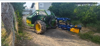
ENGATE TRASEIRO AO TRATOR E JUNTA CARDAN
