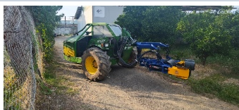
ATTACCO POSTERIORE AL TRATTORE E GIUNTO CARDANICO
